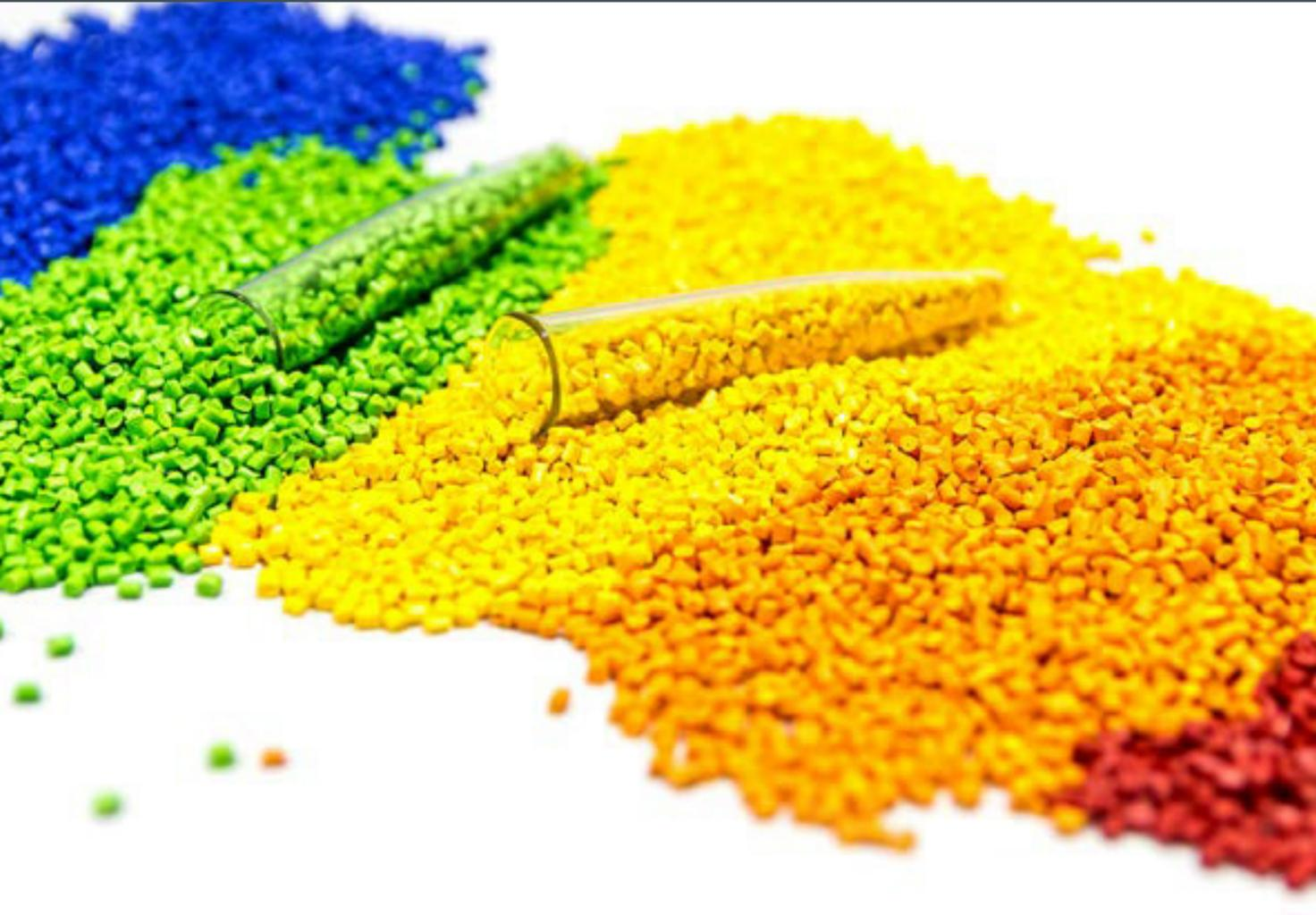
Die Qualität von Kunststoffteilen wird bei der Herstellung durch die Güte des verwendeten Kunststoffmaterials bestimmt. Für die Herstellung von Transportverpackungen werden vor allem **Copolymer - Polypropylen (PPC) und Polyethylen (PE)** verwendet.
